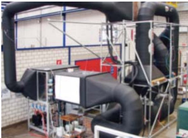
Moderne testbenk for luft/vann-varmepumper i laboratoriet ved universitetet i Lucerne
